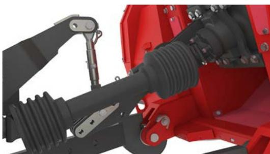
Данная W-Кинематика привода позволяет работать карданному валу всегда в максимально - горизонтальном положении, несмотря на рабочий угол.
