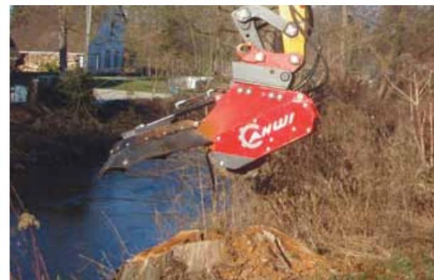
**SF600H:** Для точного фрезерования пней в труднодоступных местах.
