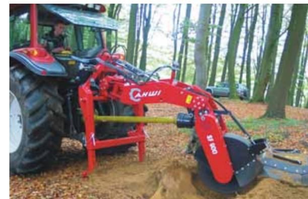
**SF900:** Фреза для пней с поворотным манипулятором, макс. глубина фрезеровки 90 см.
