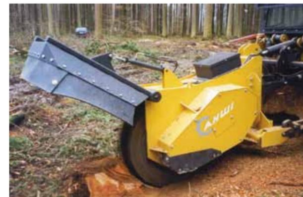
**SF1000:** Навесное оборудование для гусеничного трактора RT400, макс. глубина фрезеровки до 35 см.
