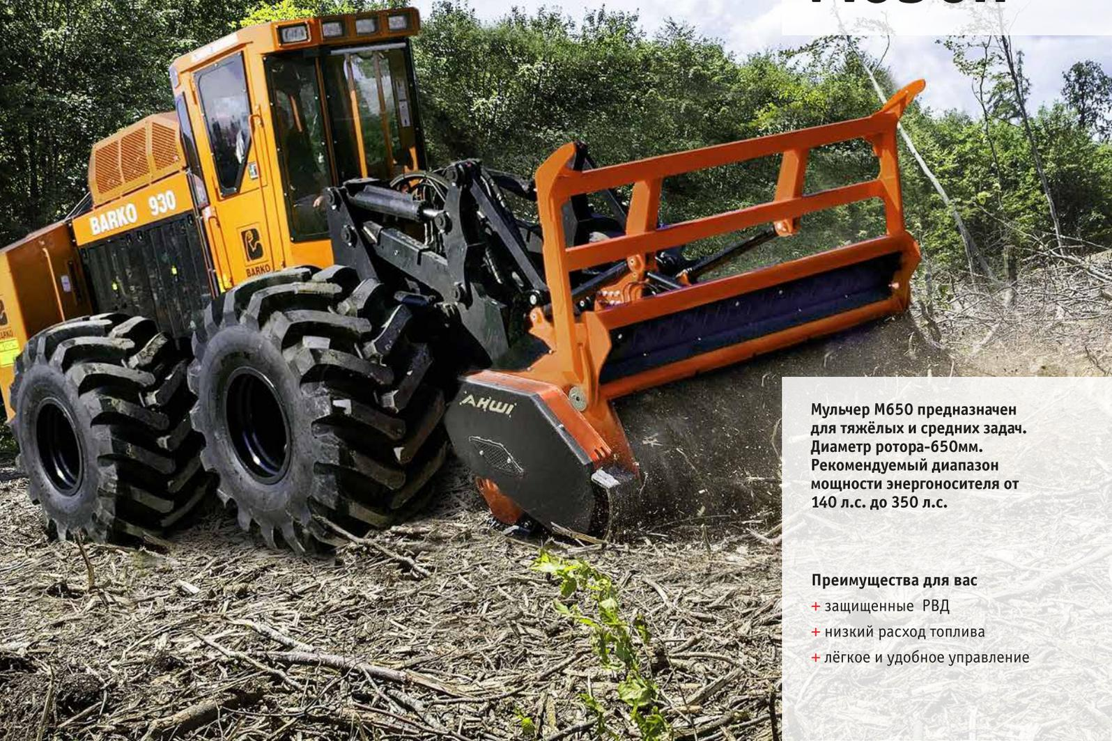
Мульчер М650 предназначен для тяжёлых и средних задач. Диаметр ротора-650мм. Рекомендуемый диапазон мощности энергоносителя от 140 л.с. до 350 л.с.
